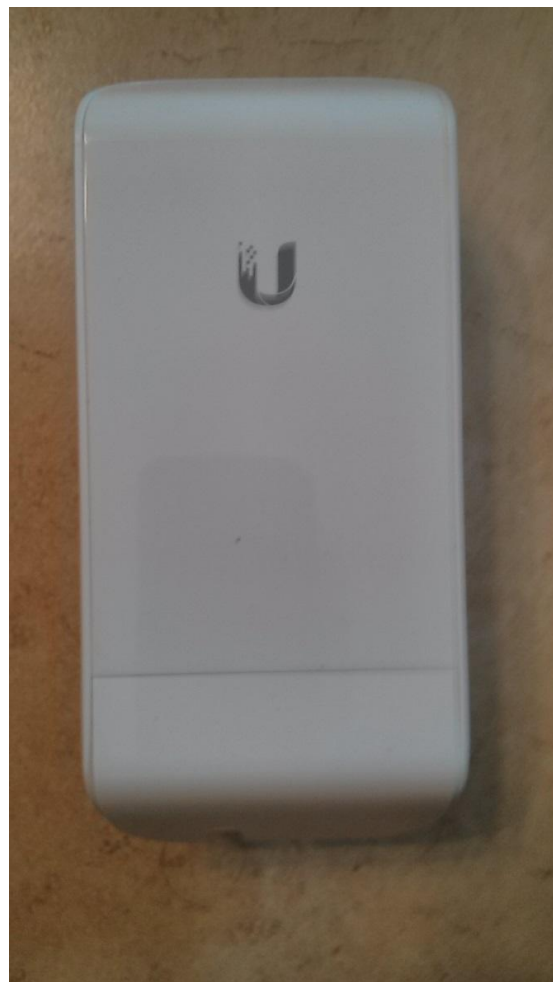
תמונה מס' 2: התקן NanoStation Loco M2 של חברת Ubiquiti לתדר של 2.4 גה"ץ
